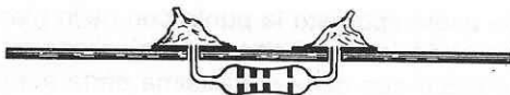
Fig.6 Con un paio di tronchesine tagliate l'eccedenza dei terminali e, come potrete constatare, lo stagno apparirà di colore "argento" e uniformemente distribuito sulla pista dello stampato.
